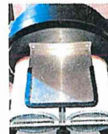
Nasssauger mit Prallblech und Filtern.
