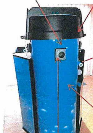
Ansicht: Nasssauger auf Schmutzwassersammelbehälter mit Saugschlauchanschluss
